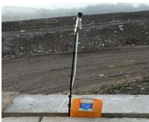
Illustration : Mesure de la qualité de l'air ambiant autour d'un casier MCCA - Tête de prélèvement utilisée sur l'ISDND de SUEZ Borde-Matin (42)
